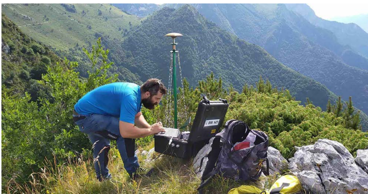
Monitoraggio con sensori GNSS.
