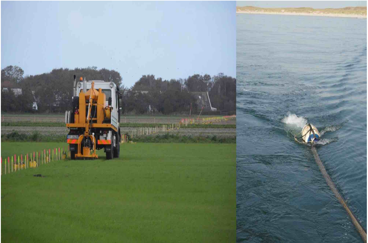
Ispezioni sismiche onshore ed offshore per la valutazione della pericolosità sismica del reattore nucleare Pallas-Petten (Netherlands).
