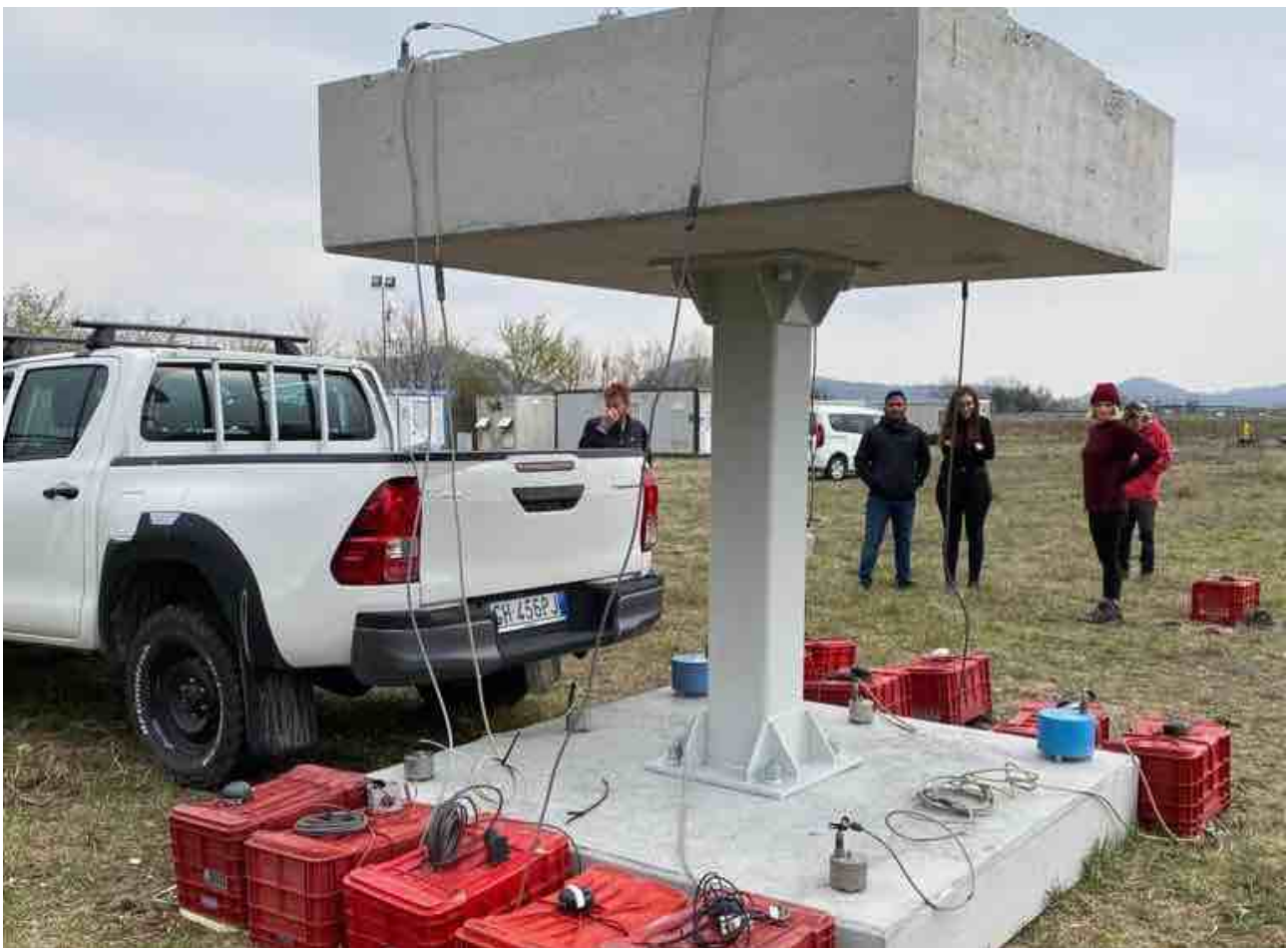
Esperimento per lo studio dell'interazione suolo-struttura.
