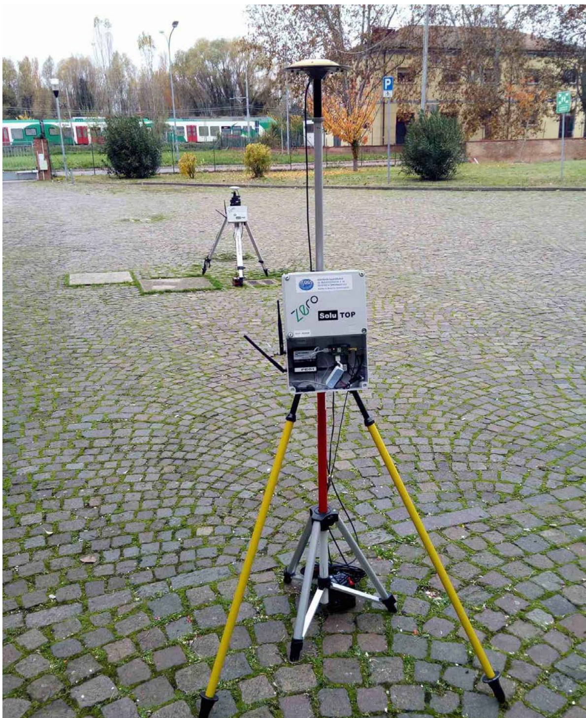
Strumentazione GNSS impiegata per rilievi di campagna.
