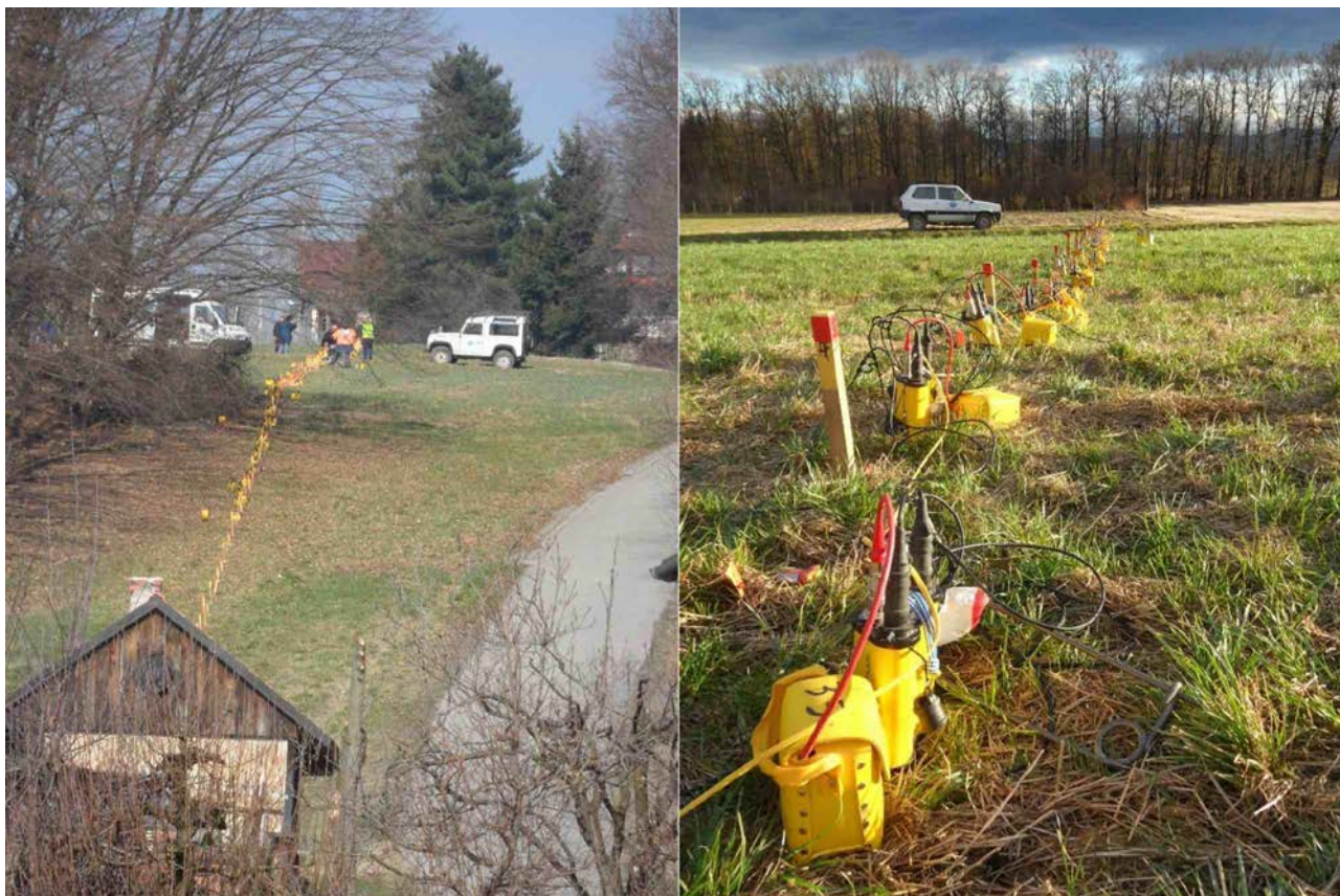
Indagine sismica a riflessione ad alta risoluzione SH-wave per la caratterizzazione del sito Nuclear Power Plant Krsko, Slovenia.
