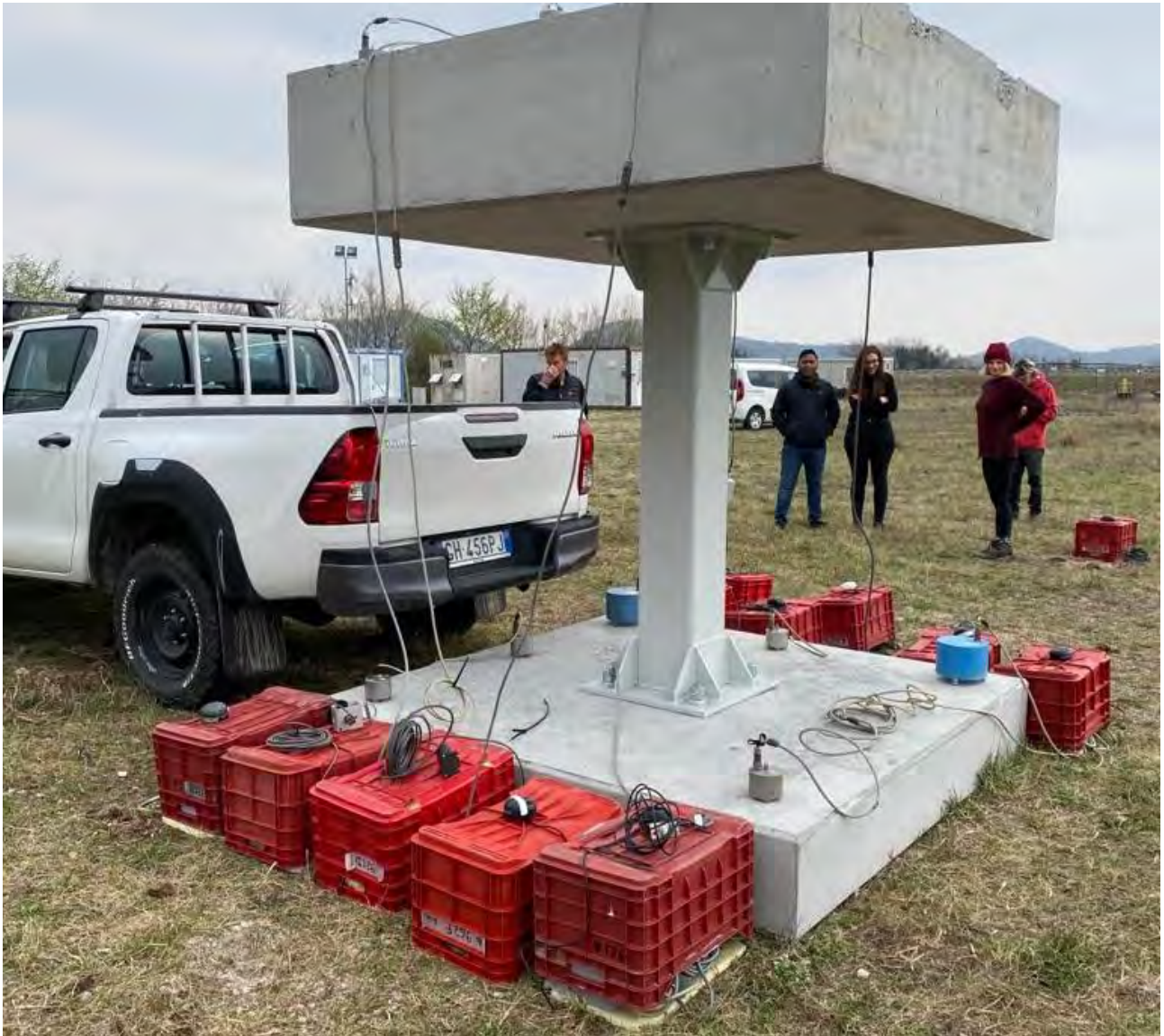
Esperimento per lo studio dell'interazione suolo-struttura.
