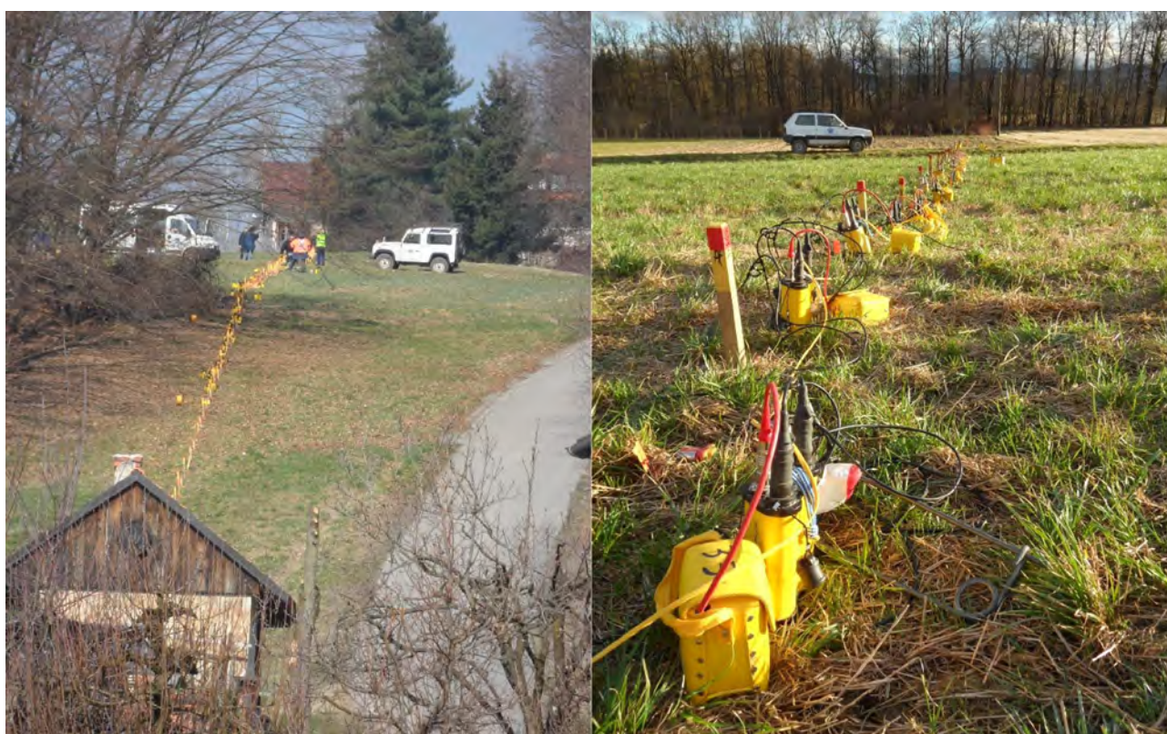
Indagine sismica a riflessione SH-wave per la caratterizzazione del sito Nuclear Power Plant Krško, Slovenia.
