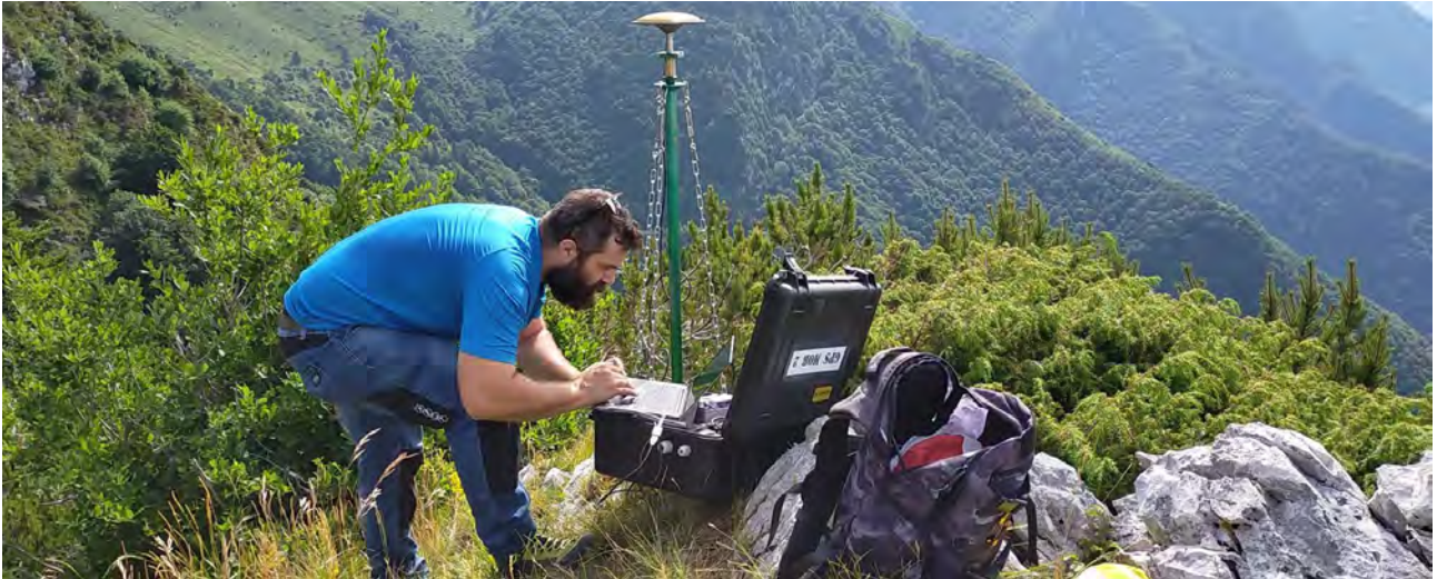
Monitoraggio di frane con sensori GNSS.
